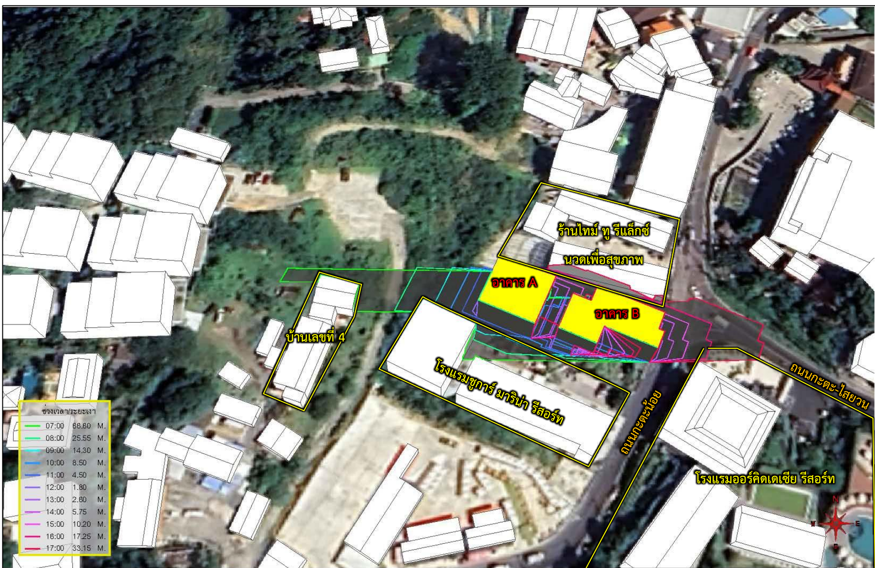
รูปที่ 4.3.8-6 แบบจำลองการบังแสงต่อพื้นที่ทุกชั่วโมงที่ทำการจำลอง วันที่ 21 เดือนกันยายน
