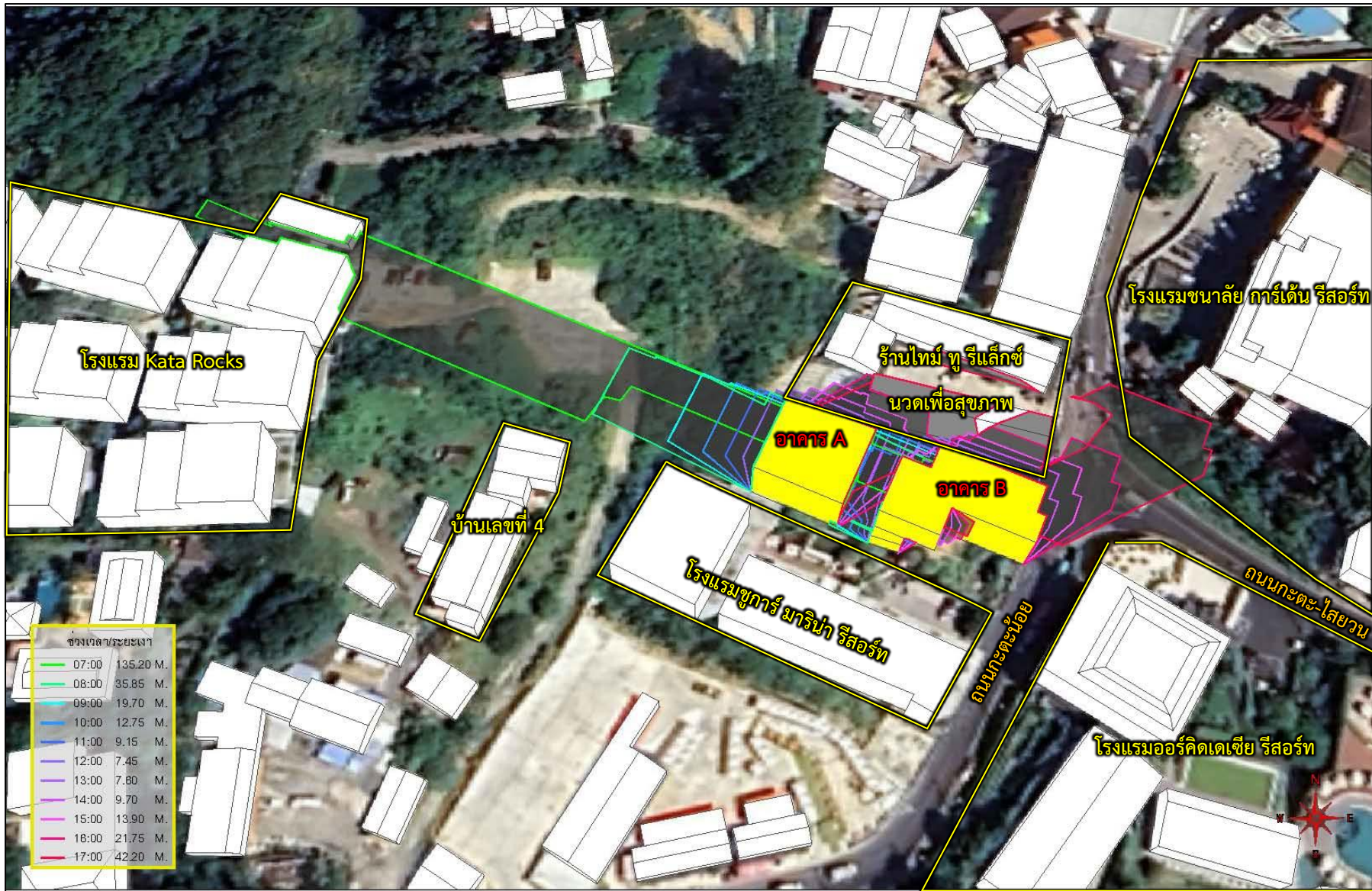
รูปที่ 4.3.8-8 แบบจำลองการบังแสงต่อพื้นที่ทุกชั่วโมงที่ทำการจำลอง วันที่ 21 เดือนธันวาคม
