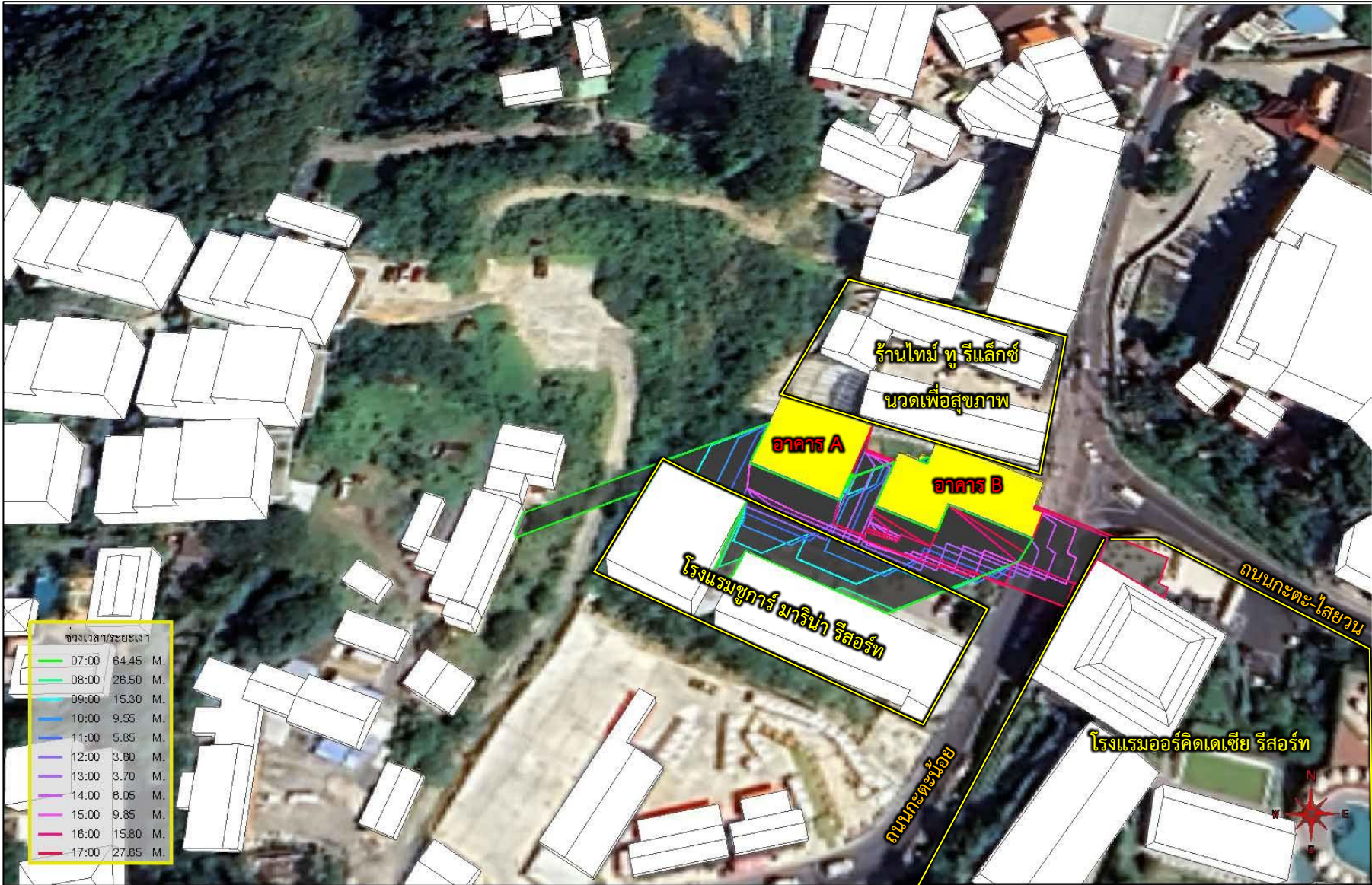
รูปที่ 4.3.8-4 แบบจำลองการบังแสงต่อพื้นที่ทุกชั่วโมงที่ทำการจำลอง วันที่ 21 เดือนมิถุนายน
